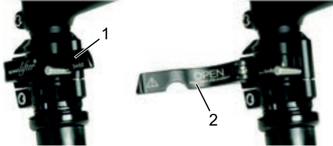
Illustration 39 : Levier de serrage fermé (1) et ouvert (2) sur la potence, exemple d'un by.schulz speedlifter
