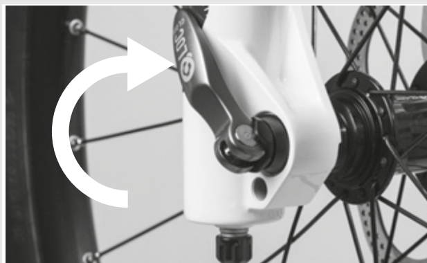
Figura 37: Chiusura del bloccaggio rapido
