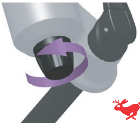
Figura 92: Rotazione dell'ammortizzatore a stadi di trazione in direzione lepre
