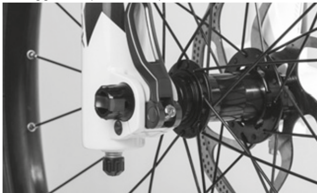
Figura 84: Regolazione della forza di serraggio del bloccaggio rapido
