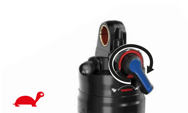
Figura 66: Riduzione della velocità di estensione
