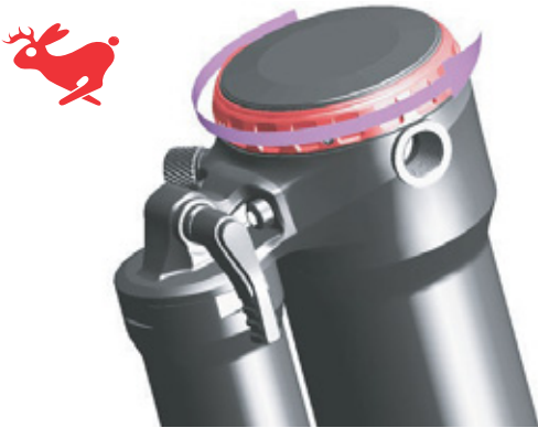
Figura 100: Rotazione dell'ammortizzatore a stadi di trazione in direzione lepre
