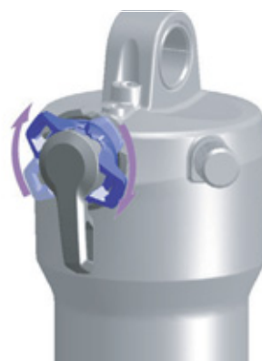
Figura 71: Regolazione più rigida del regolatore dello stadio di compressione
