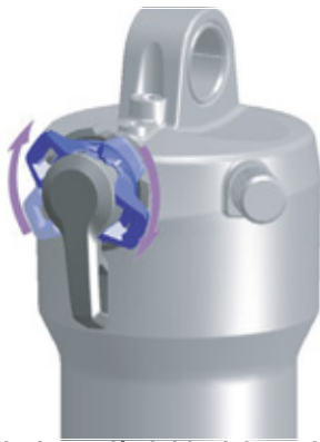
Figura 102: Regolazione più rigida del regolatore dello stadio di compressione
