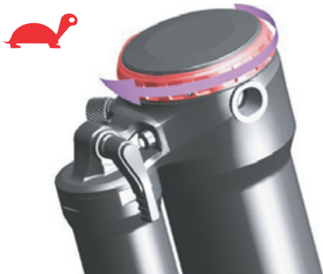
Figura 98: Rotazione dell'ammortizzatore a stadi di trazione in direzione tartaruga
