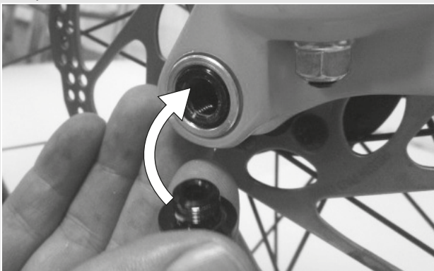
Figura 24: Applicazione della leva del bloccaggio rapido nel perno
