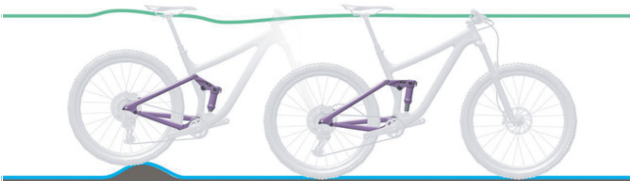
Figura 69: Comportamento di marcia ottimale dell'ammortizzatore del carro posteriore su asperità
