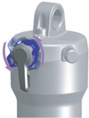
Figura 104: Regolazione più morbida del regolatore dello stadio di compressione
