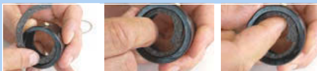
Obr. 449: Vložení plstěného kroužku
