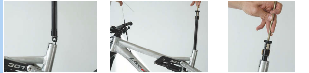
Obr. 429: Upevnění krytu ventilku kazety
