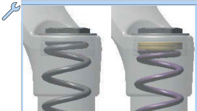
Obr. 243: Otáčení nastavovacího kroužku předpětí dovnitř a ven
