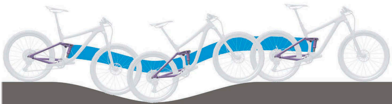
Obr. 10: Optimální chování tlumiče zadního odpružení při jízdě v kopcovitém terénu
