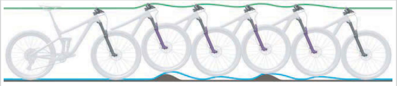
Obr. 471: Příliš rychlé roztahování odpružené vidlice
