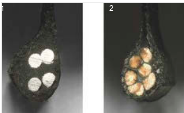
Obr. 44: Ocelová patka (1) a kevlarová patka (2)
