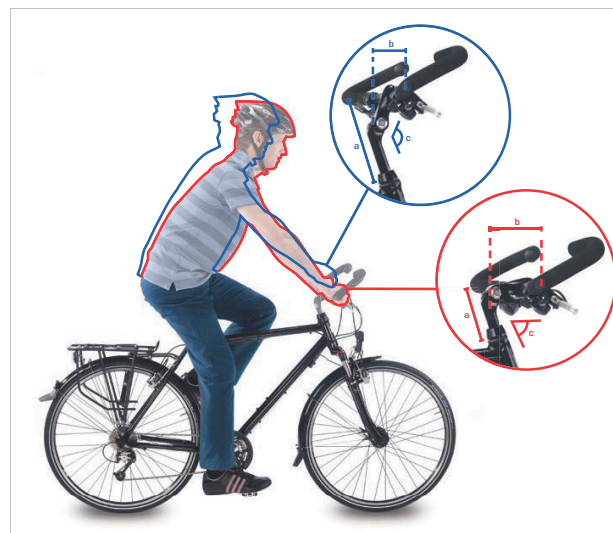
Obr. 214: Poloha u městského (modrá) a trekingového kola (červená) při změně úhlu
