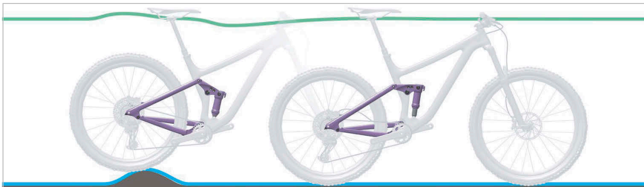
Obr. 316: Optimální chování tlumiče zadního odpružení při jízdě u nerovností
