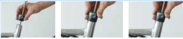
Obr. 433: Nasazení vnějšího pouzdra
