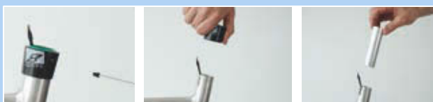
Obr. 409: Demontáž vnějšího pouzdra a kluzného pouzdra
