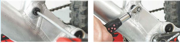
Obr. 431: Upevnění osy Postpin
