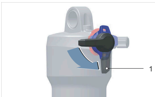
Obr. 312: Otevřená poloha (1) nastavovacího šroubu komprese (černá)
