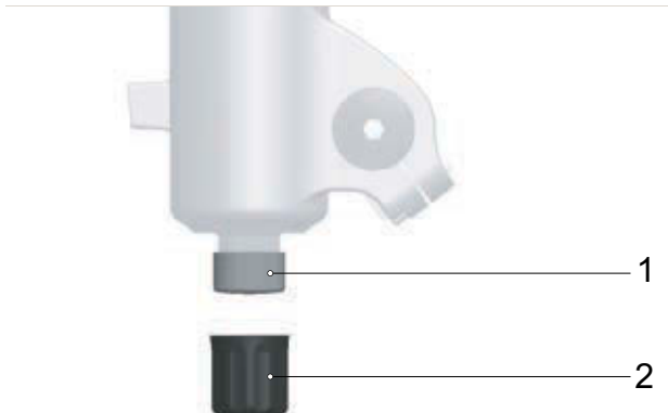
Obr. 486: Nastavovací šroub odskoku FOX (vidlice) (1) pod krytkou vidlice (2)
