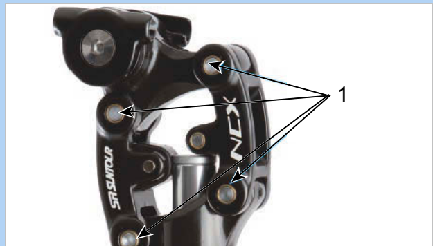
Obr. 400: Mazací body odpružené sedlovky SR SUNTOUR
