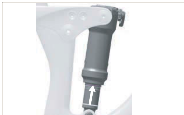
Obr. 248: Posunutí O-kroužku na tlumiči zadního odpružení
