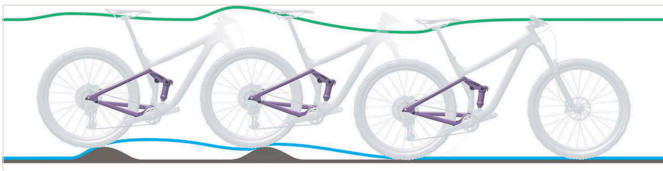
Obr. 497: Příliš pomalé roztahování tlumiče zadního odpružení
