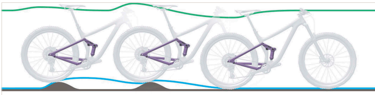
Obr. 513: Příliš pomalé roztahování tlumiče zadního odpružení
