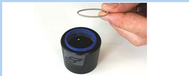
Obr. 410: Vyjmutí pružné podložky
