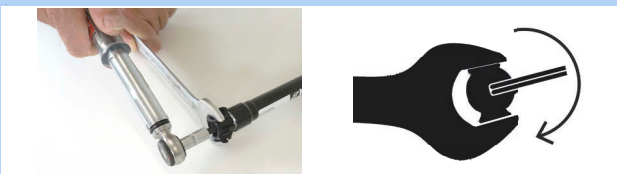
Obr. 423: Nastavení ve směru pohybu hodinových ruček
