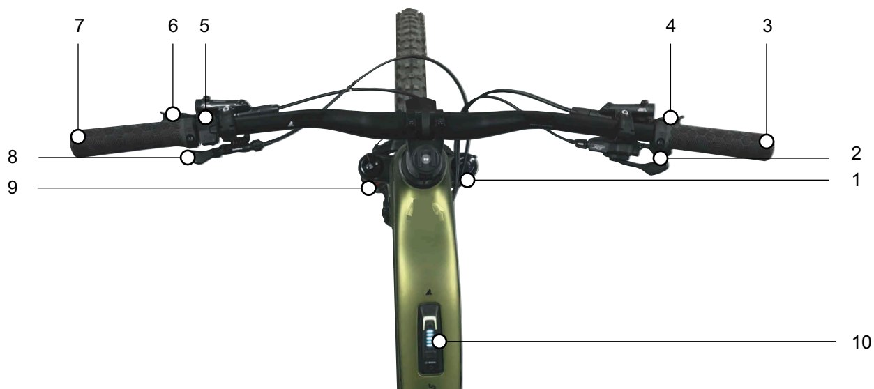
Obr. 121: Detailní pohled na řídítka s palubním počítačem System Controller BOSCH a ovládací jednotkou Mini Remote, příklad
