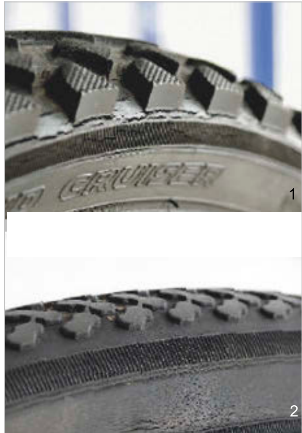
Obr. 368: Příklady únavových trhlin (1) a trhlin vzniklých stárnutím (2)
