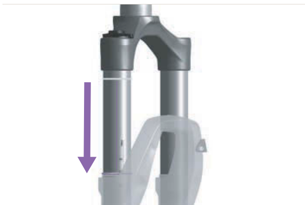
Obr. 234: Posunutí O-kroužku odpružené vidlice
