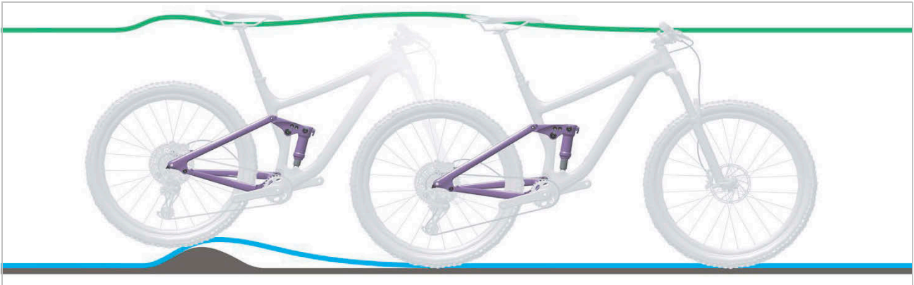
Obr. 501: Příliš tvrdé tlumení tlumiče zadního odpružení u nerovnosti
