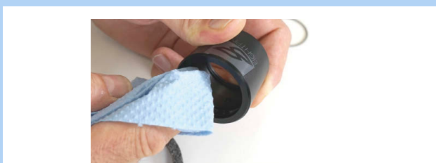
Obr. 448: Čištění vnějšího pouzdra
