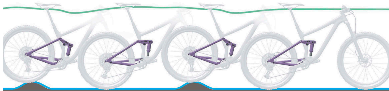
Obr. 9: Optimální chování tlumiče zadního odpružení při jízdě
