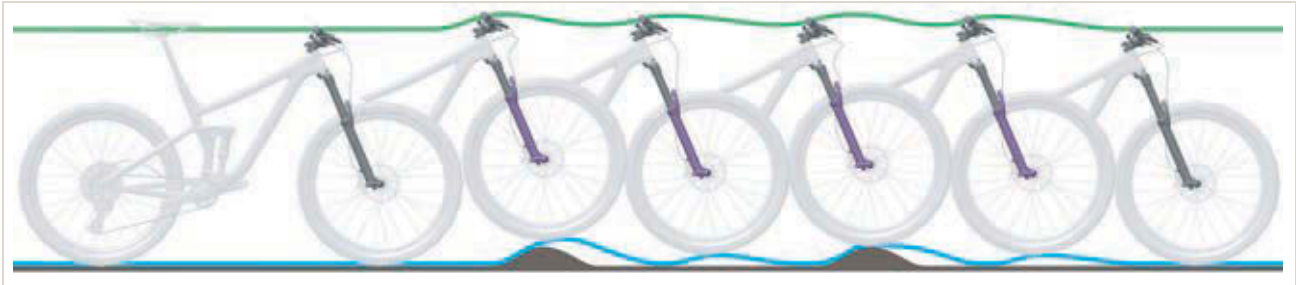
Obr. 485: Příliš rychlé roztahování odpružené vidlice
