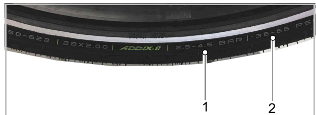
Obr. 366: Údaj tlaku v barech (1) a psi (2)
