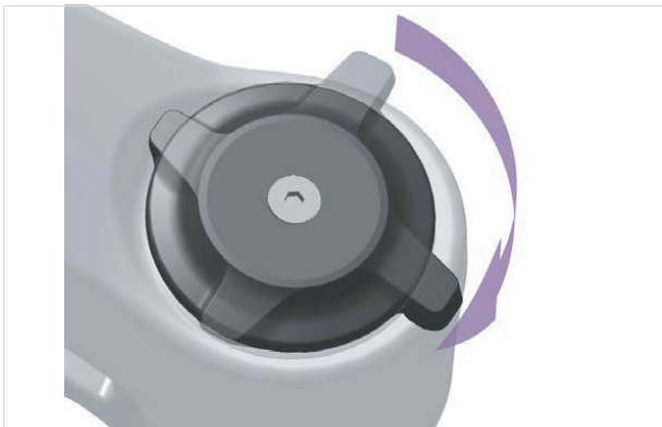
Obr. 482: Tvrďší nastavení nastavovacím šroubem komprese
