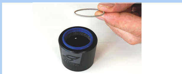
Obr. 445: Vyjmutí pružné podložky
