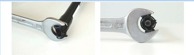
Obr. 422: Zabezpečení proti otáčení
