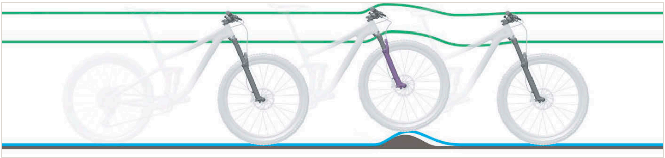
Obr. 483: Příliš tvrdé tlumení odpružené vidlice u nerovnosti
