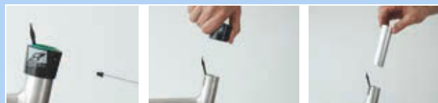
Obr. 443: Demontáž vnějšího pouzdra a kluzného pouzdra
