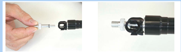
Obr. 418: Zašroubování adaptéru ventilu
