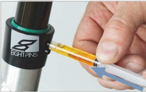
Obr. 365: Namazání sedlovky EIGHTPINS
