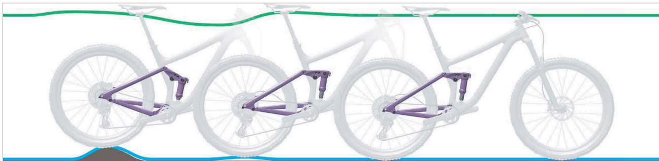
Obr. 503: Příliš rychlé roztahování tlumiče zadního odpružení
