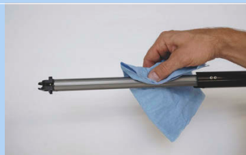
Obr. 454: Očištění podélné vodicí drážky
