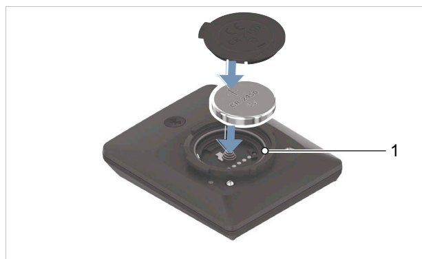
Obr. 267: Vložení baterie se správně vyrovnanou těsnicí gumou (1)
