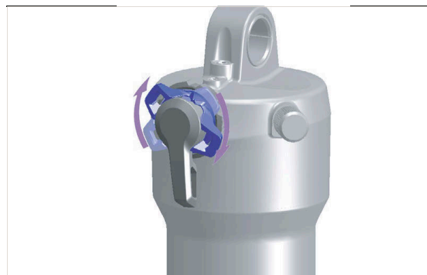
Obr. 314: Tvrdší nastavení nastavovacím šroubem komprese
