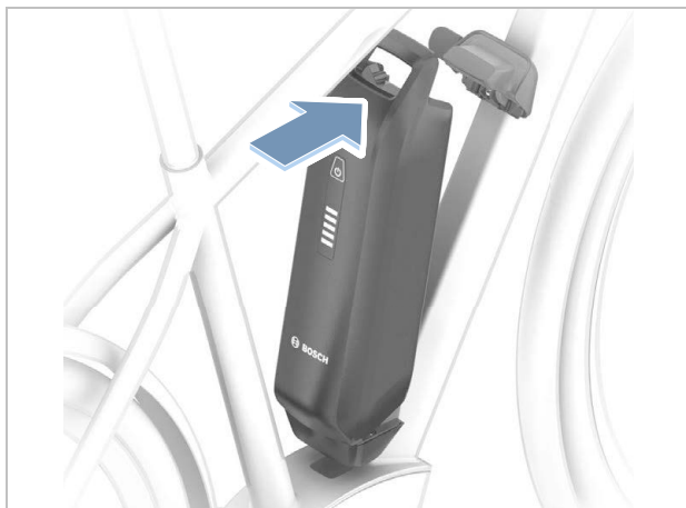
Obr. 300: Vyklopení akumulátoru PowerPack nahoru
