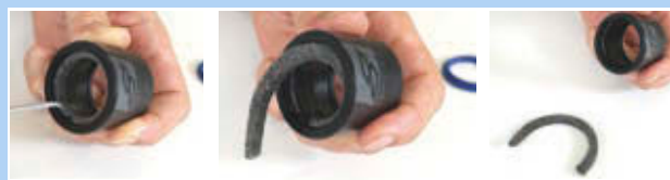
Obr. 412: Odstranění plstěného kroužku
