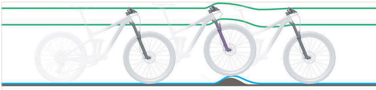
Obr. 492: Příliš tvrdé tlumení odpružené vidlice u nerovnosti
