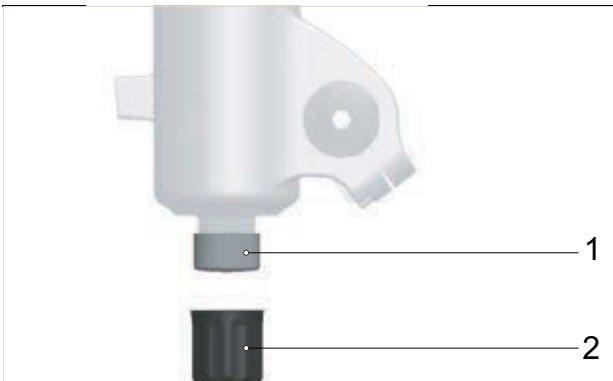
Obr. 488: Nastavovací šroub odskoku FOX (vidlice) (1) pod krytkou vidlice (2)
