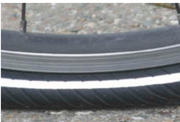
Obr. 217: Příliš nízký tlak
