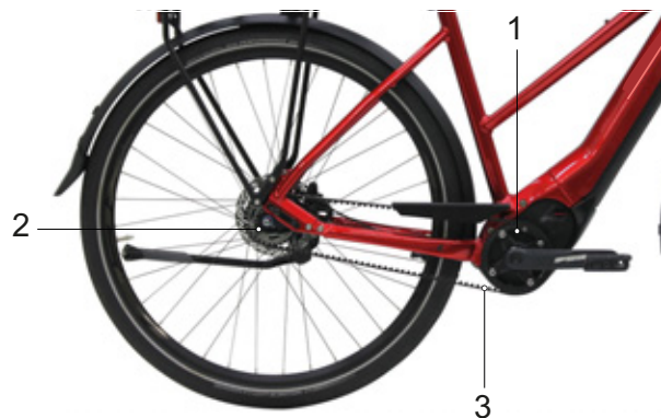
33 paveikslėlis. Diržinės pavaros schema
