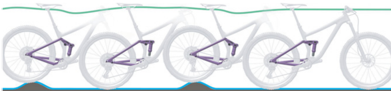
95 paveikslėlis. Optimali galinio amortizatoriaus važiavimo charakteristika
