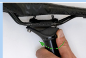
201 paveikslėlis. Uždarykite aukščio reguliavimo svirtį
