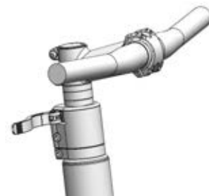
125 paveikslėlis. „All Up“ su atidaryta vairo iškyšos įtempiamąją svirtimi
