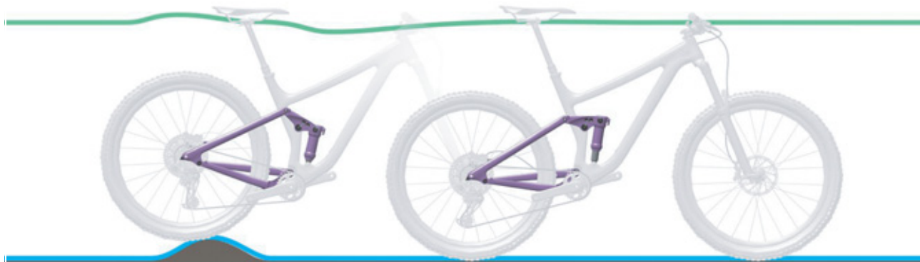
96 paveikslėlis. Optimali galinio amortizatoriaus važiavimo charakteristika nelygumuose
