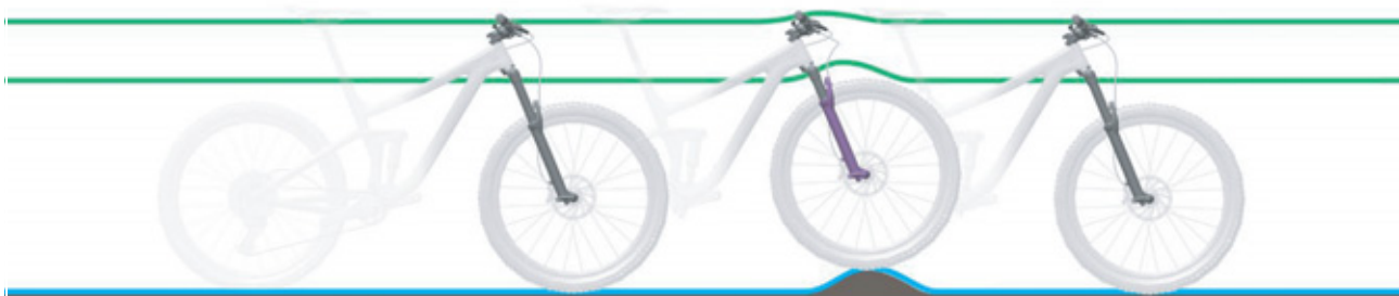
10 paveikslėlis. Optimali šakių važiavimo charakteristika nelygumuose
