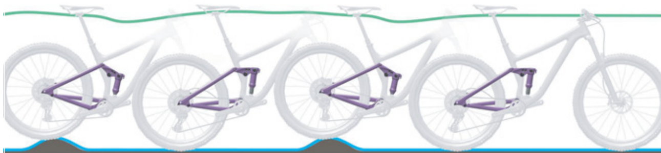
18 paveikslėlis. Optimali galinio amortizatoriaus važiavimo charakteristika
