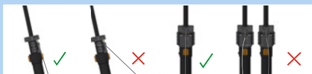
Figura 157: Cable Bowden correcto e incorrecto
