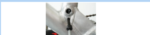
Figura 133: Soltar el eje Postpin
