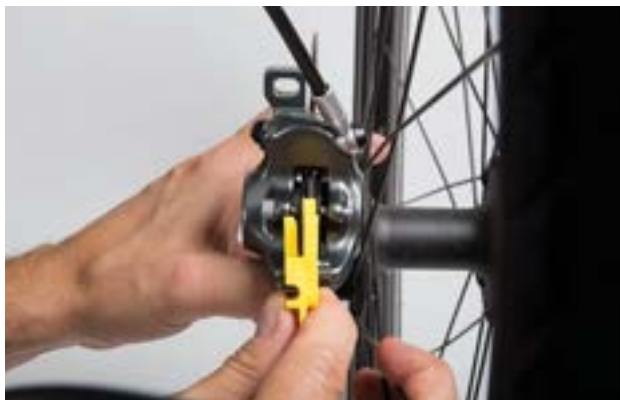
Figura 119: Comprobación de la almohadilla de freno montada con ayuda del seguro de transporte
