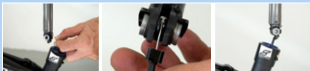
Figura 188: Enganchar e insertar la tija de sillín
