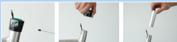
Figura 138: Desmontaje del manguito exterior y del casquillo deslizante
