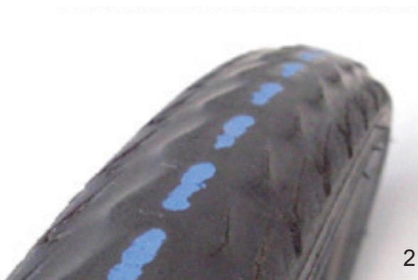
Figura 117: Cubierta sin perfil que aún puede utilizarse (1); cubierta con protección contra pinchazos visible que tiene que cambiarse (2)
