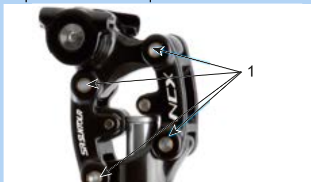
Figura 129: Puntos de lubricación de la tija de sillín de muelle SR Suntour
