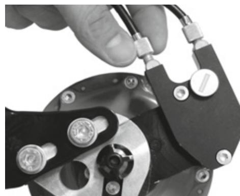
Figura 123: Las versiones de bujes Rohloff con activación de cambio externa tienen los dispositivos de ajuste de tensión en la caja de cables que se encuentra en el lado izquierdo
