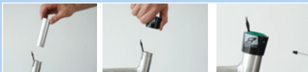
Figura 187: Montaje del casquillo deslizante y del manguito exterior
