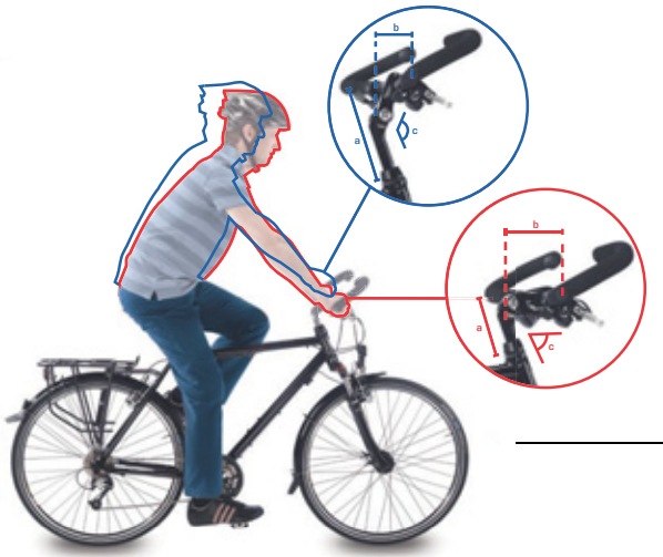
Illustration 72 : Position sur vélo de ville (en bleu) et sur vélo tout chemin (en rouge) avec modification de l'angle
