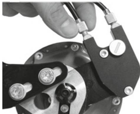
Illustration 123 : Sur les versions de moyeux ROHLOFF avec commande externe du changement de vitesse, le dispositif de réglage de la tension est situé sur le boîtier de câbles qui est placé sur le côté gauche.
