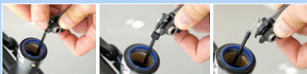
Illustration 171 : Retirer le câble Bowden
