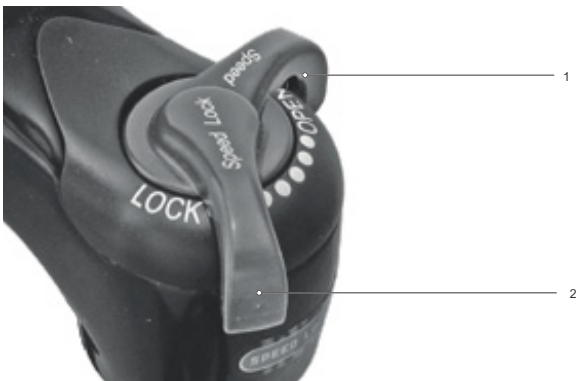
Illustration 197 : Régler le dispositif de réglage de la compression sur un niveau plus dur
