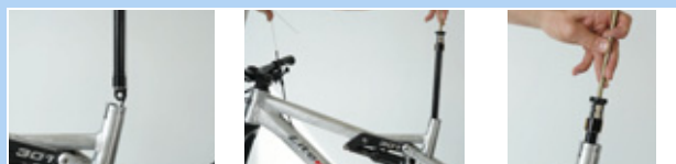
Illustration 158 : Fixer le couvercle de valve de la cartouche
