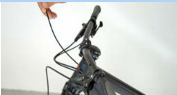
Illustration 189 : Accrocher le capuchon d'extrémité
