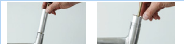
Illustration 161 : Insérer le tube de la douille de glissement dans le tube de selle
