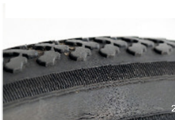
Illustration 118 : Exemples de fissures de fatigue (1) et de fissures d'âge (2)
