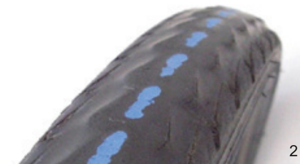
Illustration 117 : Pneu sans profil pouvant encore être utilisé (1) et pneu avec bande de protection visible (2) devant être changé
