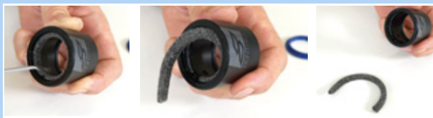
Obr. 158: Odstranění plstěného kroužku
