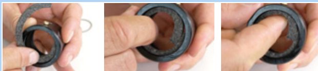
Obr. 160: Vložení plstěného kroužku
