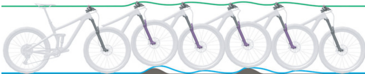
Obr. 209: Příliš rychlé roztahování odpružené vidlice
