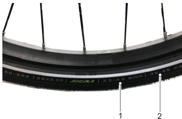
Obr. 133: Plnicí tlak v barech (1) a psi (2)
