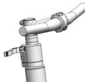
Obr. 127: All Up s otevřenou upínací pákou představce
