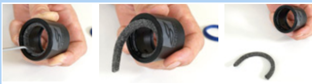
Obr. 193: Odstranění plstěného kroužku
