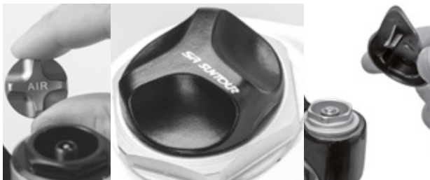
Obr. 99: Šroubovací krytka může mít různé provedení
