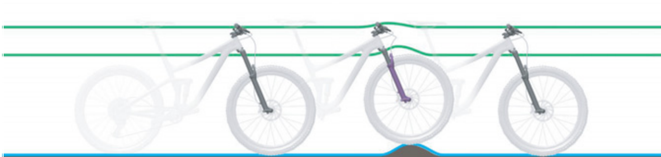
Obr. 10: Optimální chování vidlice při jízdě u nerovností
