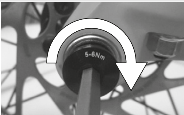
Figura 28: Serraggio della vite di sicurezza
